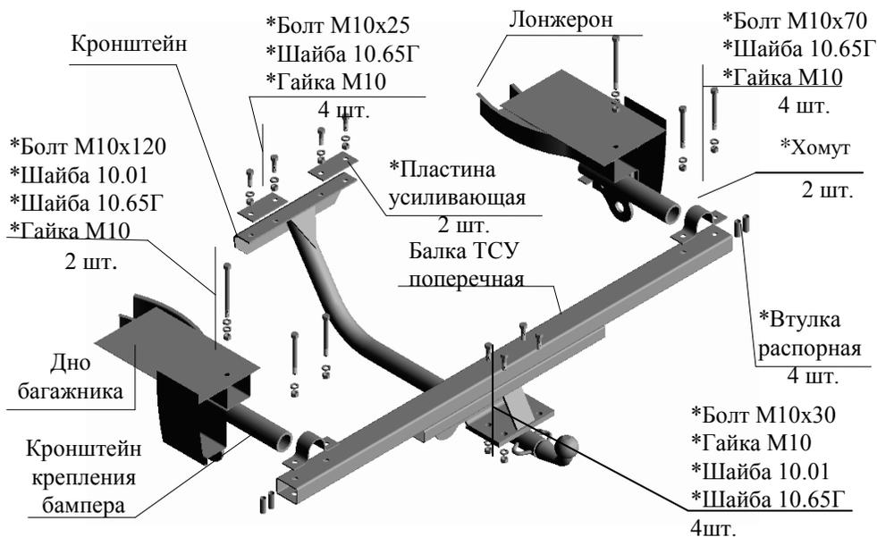
**Примечание:** детали, помеченные \* входят в пакет комплектующих РИС.1 Тягово-сцепное устройство ТСУ 2121.01.Р исп.2
