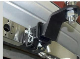
Тип соединения: шаровый; Тип шара «Е»; Диаметр сцепного шара: 50 мм.; Масса комплекта ТСУ LRX991103: 18,7 кг.
