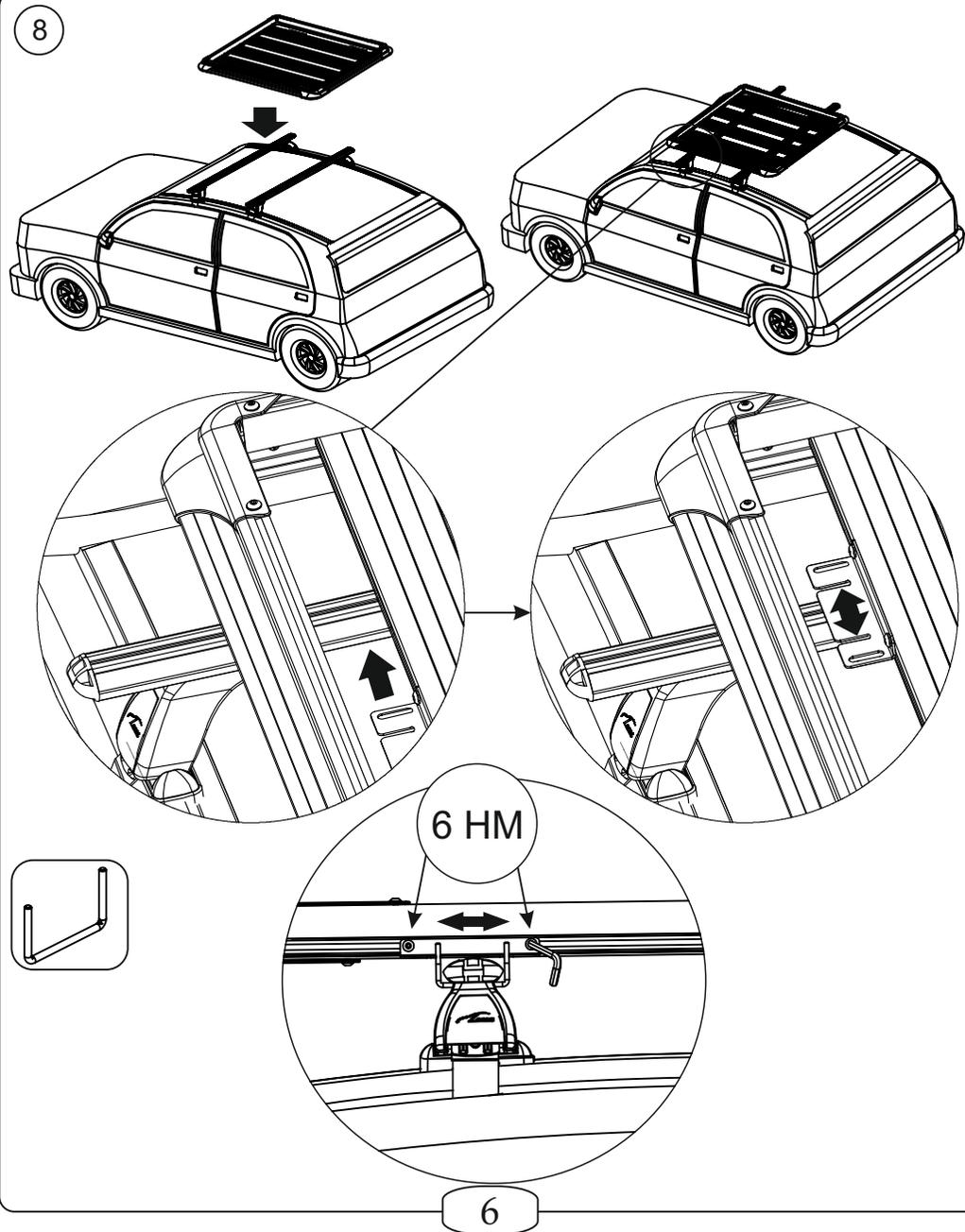
**ИНСТРУКЦИЯ ПО УСТАНОВКЕ Корзины багажной LUX РАЙДЭР**
