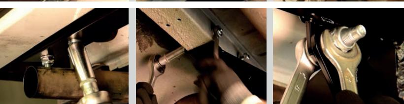
**ШАГ 5.** Установите кронштейн крепления электрической розетки. Установите съемный шар в сборе и закрепите его пальцем гнутым с шплинтом. Зафиксируйте съемный шар винтом M10x20 снизу. Установка завершена.
