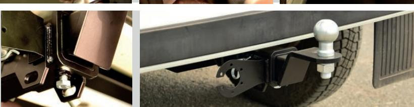
Тип соединения: шаровый; Диаметр сцепного шара: 50 мм.; Масса комплекта ТСУ 01211501: 12 кг.
