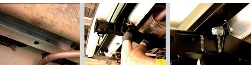
**ШАГ 3.** Совместите отверстия в кронштейне с отверстиями в лонжероне и проденьте сквозь отверстия лонжерона болты M10x90. Закрепите всё с помощью самоконтрящихся гаек M10 через шайбы M10 увеличенные.
